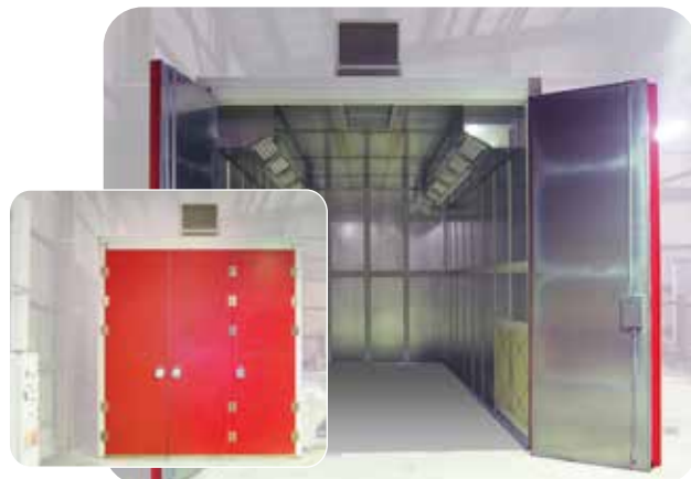
バジ式乾燥炉(使用温度200℃) 外気導入アフターパージのため冷却効果が優れています。
